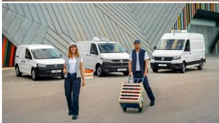
**Crafter Box/Fresh:** El vehículo tiene integrado una caja paquetera o caja isothermizada según necesidad. Está creado sobre la versión de 3,5t y dispone de 3 configuraciones de caja de los 3,8m a los 4,3m de largo y de los 2,1m a los 2,3m de alto (volúmenes de 18m<sup>3</sup> a 22m<sup>3</sup> de carga). El isoterma (FRESH) tiene opción de incluir equipo de frío.
